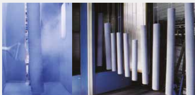
Instalación "bombardeo" de partículas y pintado en polvo.
