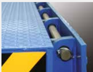
Ejes del labio y bisagras: bicromatado electrolítico para prever la corrosión. Bisagras autolimpiables. (Eje Ø29 mm.)
