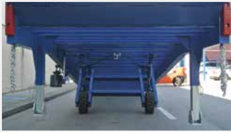
Pies de apoyo y seguridad (posición reposo). Ruedas de mayor tamaño para garantizar una mayor estabilidad.
